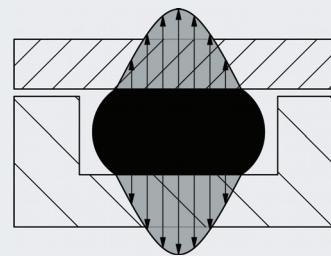
Initiële voorspanning na de montage
